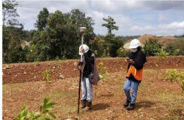
Gambar 1. Pengkoneksian antara handcontrol dengan receiver
